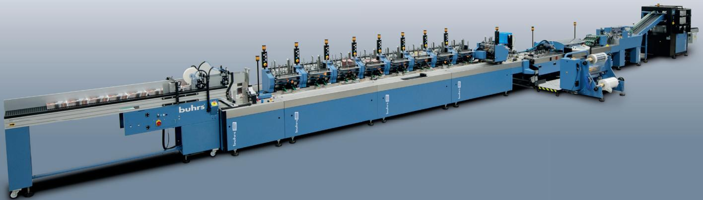
Das **Buhrs 3000 Compact Poly- & Papierverpackungssystem** ist der Standard in Leistung und Design. Das System hat eine kleine Stellfläche und die richtige Höhe für eine ergonomische Beladung der Zuführungen. Zusammen mit der bekannten Buhrs-Qualität und -Zuverlässigkeit ergibt dies ein Hochleistungssystem, dass qualitativ hochwertige verpackte Produkte produziert.
