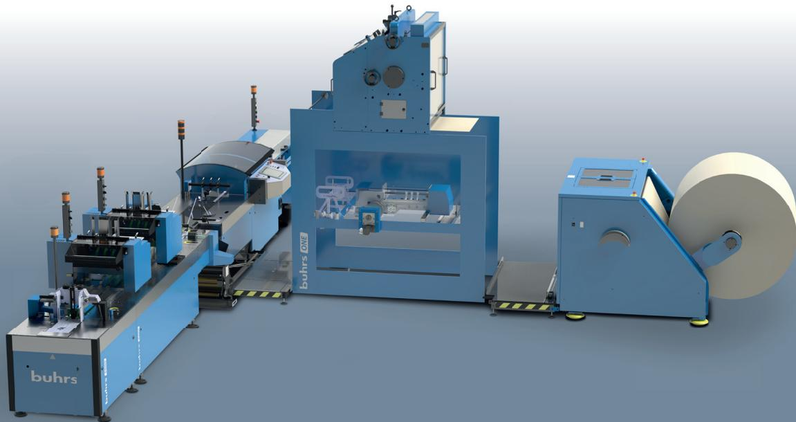
In einer Welt, in der Effizienz, Nachhaltigkeit und Flexibilität entscheidend sind, bietet die **Buhrs ONE** unübertroffene Leistung. Diese bahnbrechende Lösung kombiniert Umschlag Herstellung und Einstecken in einem einzigen, modularen System, das Ihre anspruchsvollsten Verpackungsanforderungen erfüllt.
